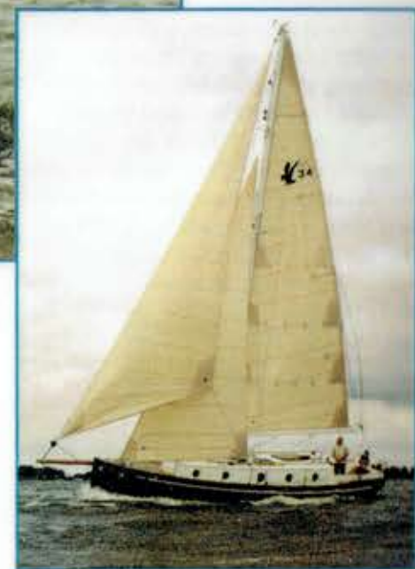
Auf Wunsch des Eigners ist die erste Puffin 36 abweichend zur Serie ohne Deckshaus gebaut worden
